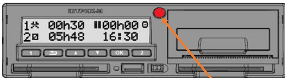
Пластиковая пломба с оттиском завода-изготовителя
